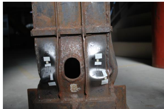
写真 2 実験後の供試体形状
