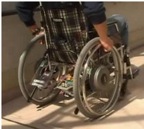
図1 傾斜対応型パワーアシスト車椅子
