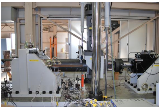
写真1 二軸載荷試験機
