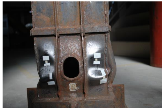
写真2 実験後の供試体形状
