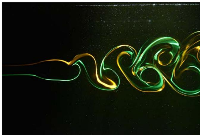
図 : 円柱後流に発生するカルマン渦
