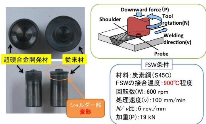
図2 摩擦攪拌接合(FSW)工具への応用
