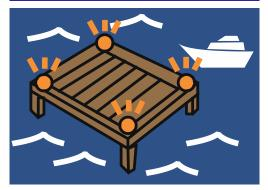
養殖用のいかだに同時発光する照明 を取り付けることで船の衝突を防止 します。
