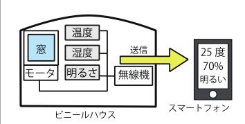
温度管理などが必要なビニールハウスなどの温度や 湿度を遠隔から監視できます。ハウスの窓の開閉も 遠隔操作することもできます。
