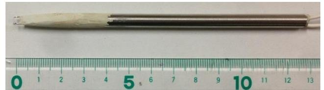
図: 自作熱線流速計センサー
