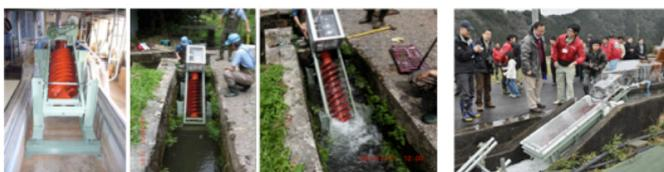
写真 螺旋水車の水理実験と現地への導入
