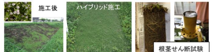
写真 イワダレソウによる法面緑化工法とせん断試験
