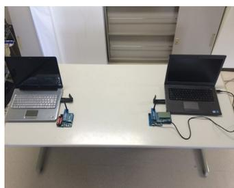
Wi-Fi, ZigBee 干渉実験
