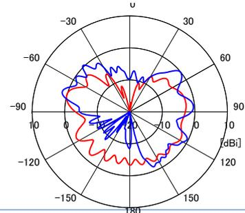
解析例：地上波デジタル放送用車載用アンテナ
