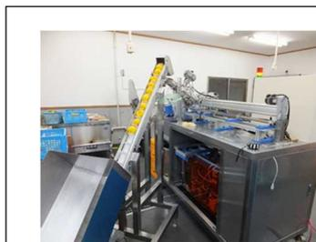
図4 北限ユズの衝撃波処理装置
