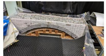
石橋模型の加振実験
