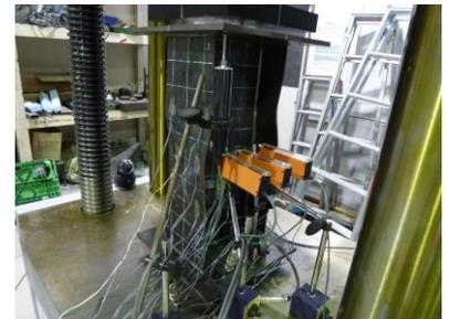
万能試験機を用いた圧縮実験
