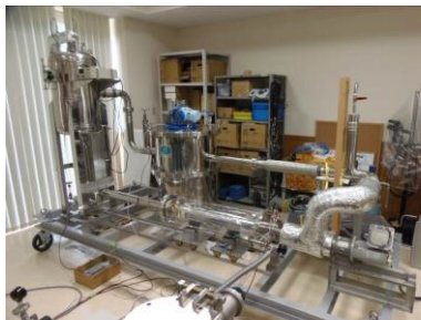
図 極低温流体輸送システム実験設備
