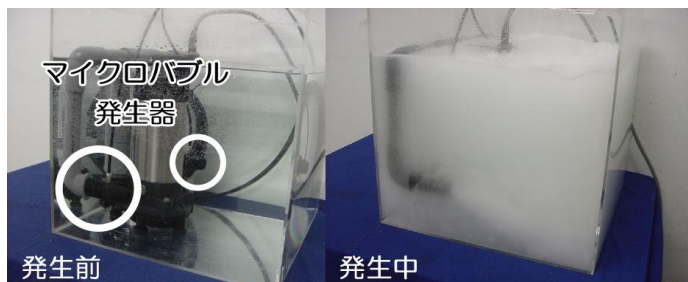
※ 地元高知県内企業(株)坂本技研と共同開発した水産向けファインバブル(マイクロ・ナノバブル)発生器
