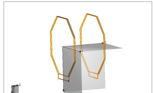
図2 送受電コイルの解析モデル
