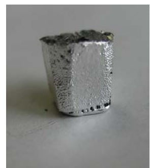
図3 アルミニウムの鋳造例
