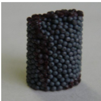
図1 炭素鋼球鋳型の試験片
