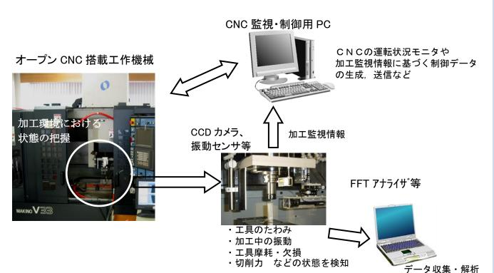
可視化技術を用いた非接触での計測技術により、インプロセスでのモニタリングを行います。また、モニタリングデータを最適加工のための加工制御の情報として活用します。
