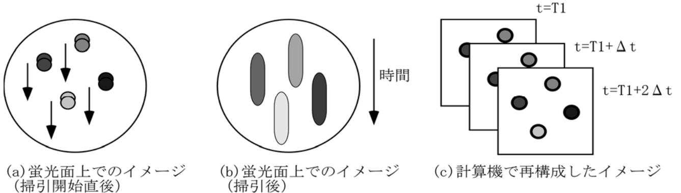
撮影原理は、分割した画像が重ならないように掃引し、図中の(b)のような画像から計算機で画像を再構成することで、20 枚程度の二次元画像を得ることです。画素数は、1万程度です。
