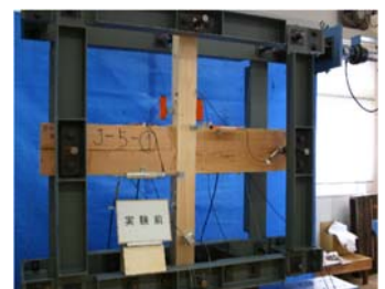
接合部のモーメント抵抗実験
