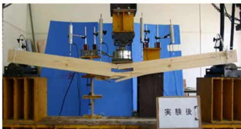
断面欠損を有する柱の曲げ実験
