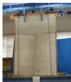
耐力壁の面内せん断試験
