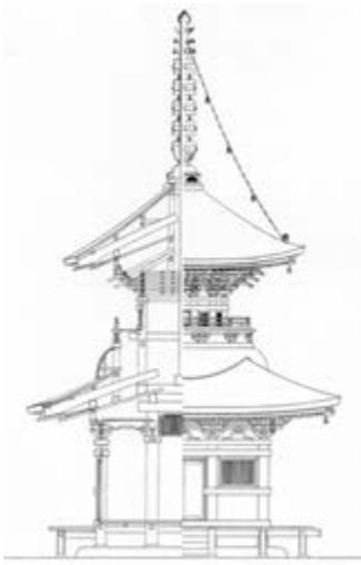
図1 史料に基づき作成した多宝塔の立・断面図
