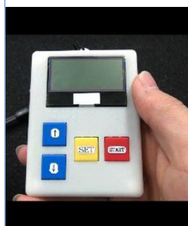
「酸素ボンベの残量計の試作」 残量計の外観と製作した基板
