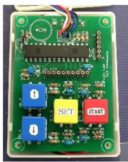
「酸素ボンベの残量計の試作」 残量計の外観と製作した基板
