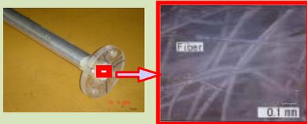
省エネルギーの観点から流体抵抗や損失を減ずる抵抗減少効果は、工学的に極めて重要な課題である。管内壁面への柔毛繊維植毛による低減方法を提案し、その流れの構造などを調べている。
