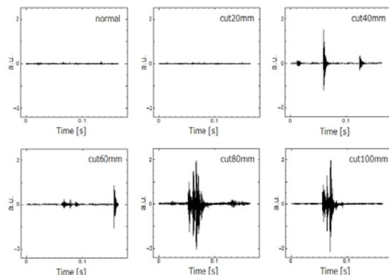
図 2. ブレード破壊の度合いと観測 AE 波
