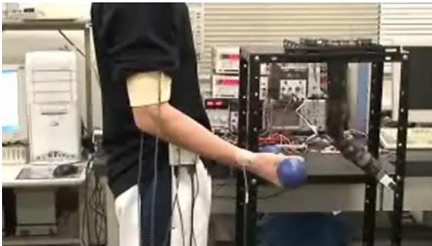
図1 表面筋電位を用いてロボットアーム制御
