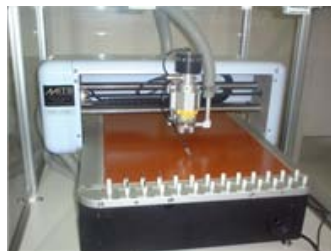
Fig. 2 自動基板加工機 (CADによる電子回路基板設計から直接試作可能)
