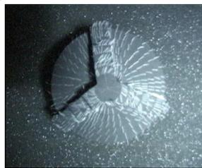
図1 煙法による可視化
