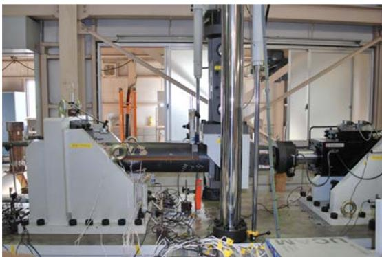
写真1 二軸載荷試験機
