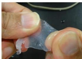
間伐材から製造した多孔質材料
