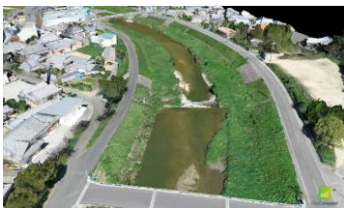
図2 香川県高瀬川における UAV を用いた地形測量結果とそれを用いた流下能力評価結果
