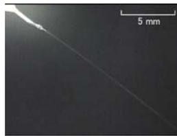
図2 液体の静電噴射
