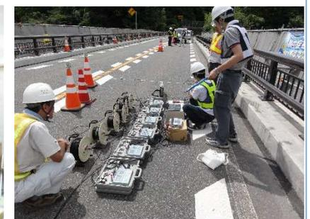
RC 構造物の載荷試験
