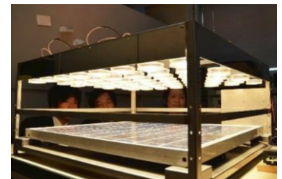
図2 PV パネル評価装置
