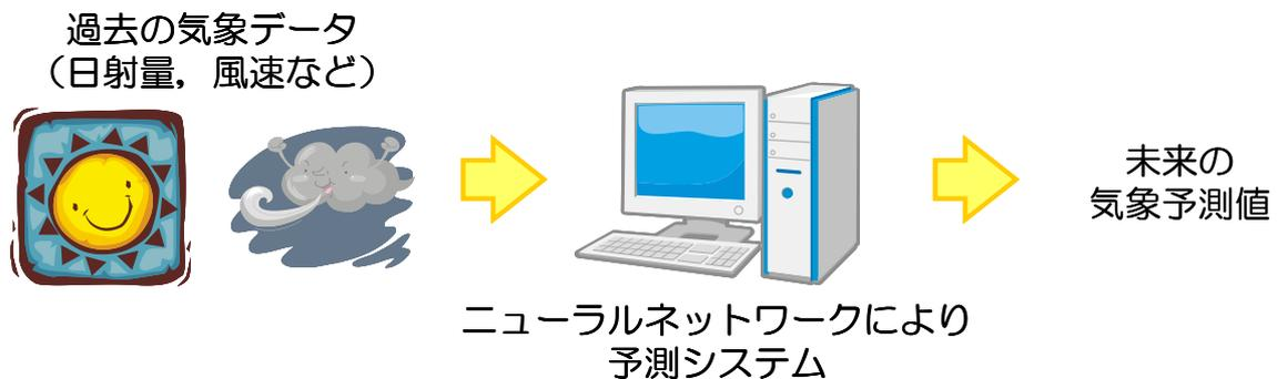
従来は、複雑な気象モデル方程式から求められた数値気象予測値(風速, 風向, 気圧など)が必要となる。そのため、気象予測システムを運用するためには、高機能な計算機が必要となり多くのコストがかかる欠点がある。本シーズは、気象観測機より得られる気象データのみを利用するため、複雑な計算を必要とせず、安価な計算機のみで予測システムを開発できる。
