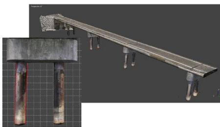
図-2 3次元形状取得による構造物の変形の定量化
