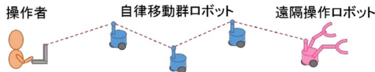
図 2. 無線遠隔操作ロボットの通信が途切れないように、中継ロボットが自律的に移動しネットワークを連結に保つ。
