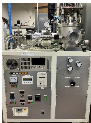
図1 RFマグネトロンスパッタ装置 (3元)
