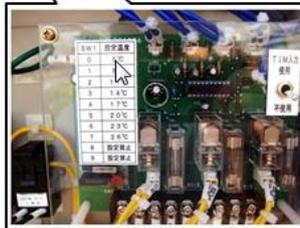
・1個のマイコンで、600W×3チャンネルのテープヒータデジタル温度制御を実現
