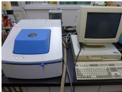
提供可能な「蛍光X線元素分析装置」は、固体試料の元素分析(11Na から 92U)が可能で、非破壊分析です。分析前の前処理も特に必要としません。本機はX線管ターゲットが Mo(モリブデン)仕様であるため、従来の Rh(ロジウム)ターゲット仕様では測定できない Ru(ルテニウム)、Rh が定量可能です。
