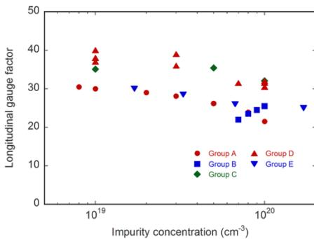
図 1. 多結晶シリコン(p型)のゲージ率
