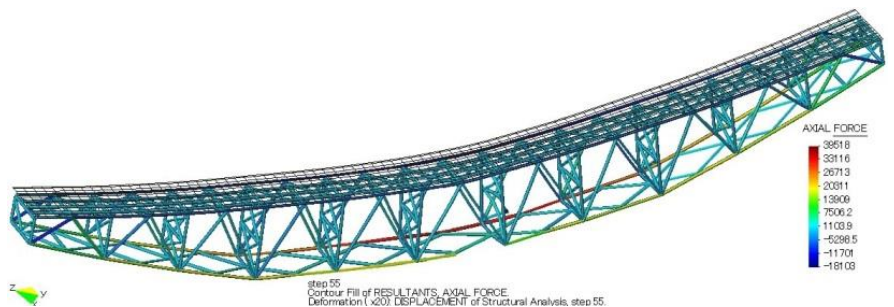
鋼トラス橋の部材破断に伴う崩壊に対する冗長性の検証解析
