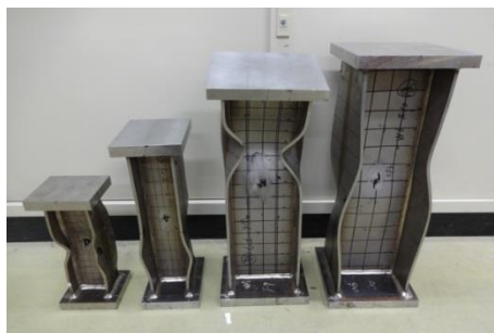
ステンレス鋼柱の圧縮試験体
