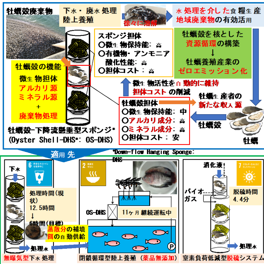
図1 牡蠣殻を活用した廃水処理・アクアポニックス・バイオガス精製技術
