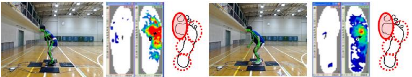
図 未熟練者（左）と熟練者（右）の最大踏力時の足圧分布および意識した部位の比較
