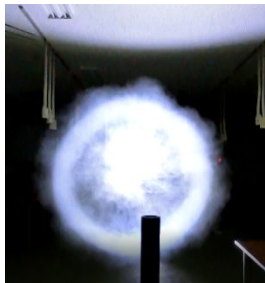
図：巨大空気砲(500mm)による渦輪の可視化写真 連続写真として編集
