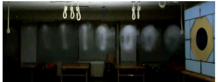
図：巨大空気砲(500mm)による渦輪の可視化写真 連続写真として編集
