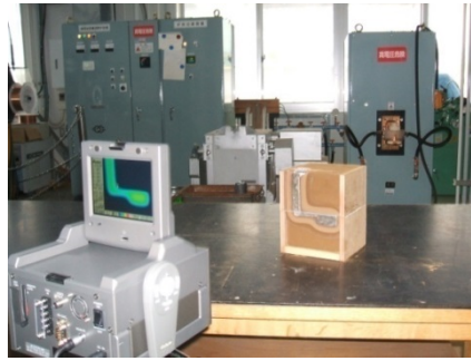
図 2 鋳造の温度分布測定
