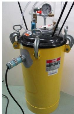
写真2 簡易密閉反応器
