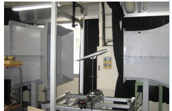
図1 エッフェル型三次元風洞 (テストセクションサイズ600mm×600mm)
