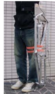
図2 下肢用のパワーアシスト装具
