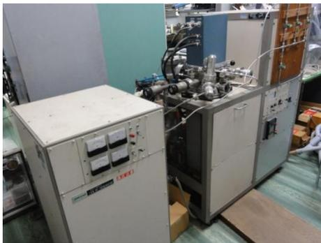
図1 スパッタリング装置
