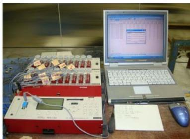
写真④ 骨材の乾燥収縮ひずみ計測
