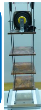
学習型マルチモード吸振システム 実験装置の外観
